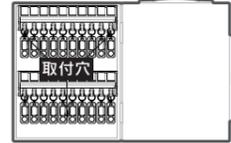
キーボックスは本体背面に取付用の穴が3ヶ所あり、付属のネジ・プラグを用いて壁面への設置が可能です。取り付けをご検討の際は下記の穴位置をご参照ください。
