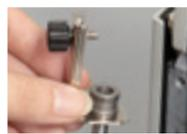
替刃交換の際にネジの紛失を防ぐロットホルダー。
